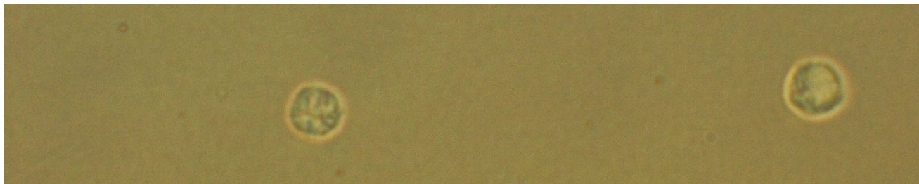
Si(111) 300mN Empreinte circulaire – toujours pas de fissure
