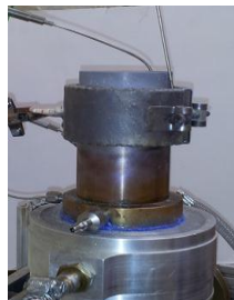
Figure 10 : Moteur avec collier chauffant
