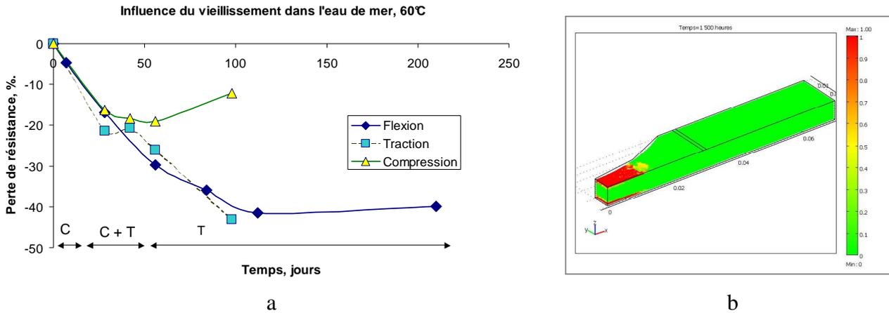
Figure 8.(a) Evolution des résistances en flexion, traction et compression de composites verre E après vieillissement, indiquant le changement de mode de rupture en flexion de Compression (C) à Traction (T), (b) Modèle numérique couplé diffusion/résistance mécanique.
