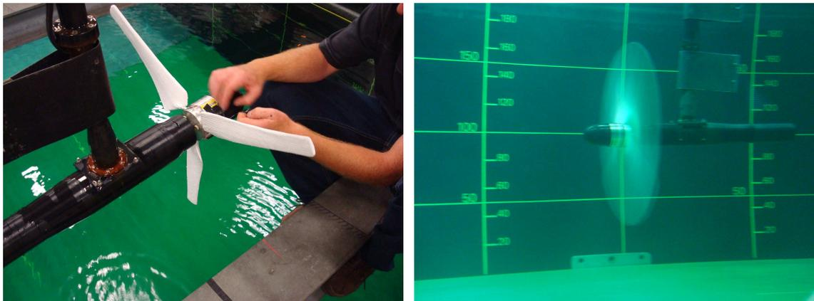
Fig. 13. Essais sur pales composites instrumentées au bassin.
