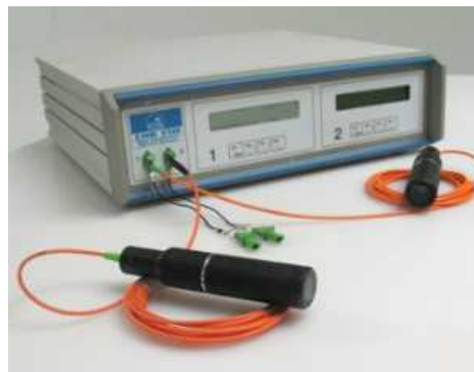
FIG. 10 - Crayon optique STIL et son contrôleur
