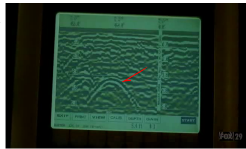
FIGURE 8 – Gauche : schéma justifiant de l’observation de réflecteurs ponctuels comme hyperbole dans un RADARgramme de RADAR à ouverture synthétique ou RADAR de sol (GPR). Rx et Tx sont l’émetteur et le récepteur du RADAR dans une configuration bistatique. Droite : capture d’écran de l’épisode 7 de la saison 1 de la série télévisée Bones (34 minutes, 11 secondes du début de l’épisode) illustrant la distribution hyperbolique des réflexions de l’objet enterré (flèche rouge), observée par GPR par l’héroïne de la série.
