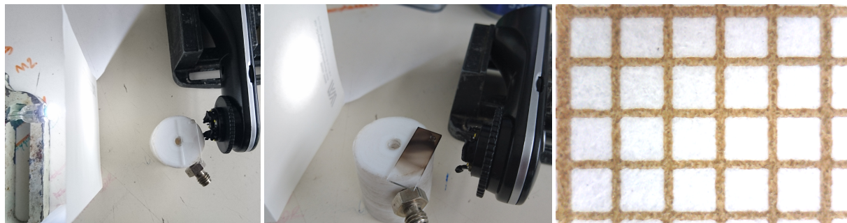
FIGURE 4 – Montage expérimental de prises de vues – une webcam munie d'un objectif dont la distance focale est compatible avec des applications de macro-photographie – avec une illumination en contre-jour pour saturer en blanc le fond de l'image et faire apparaître la goutte en sombre sur fond clair. Nous constatons (droite) en prenant une photographie de papier millimétrique gradué l'absence de déformation significative par l'optique de prise de vue.
