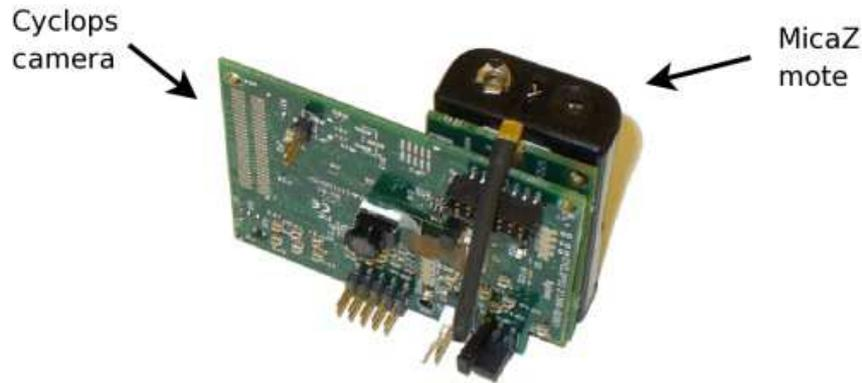
**Figure 1.4.** *Capteur multimédia Cyclops*
