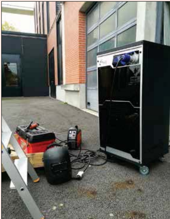
Figure 3 : Groupe électrogène à hydrogène (puissance électrique 5kW). Source : http://www.h2sys.fr .
