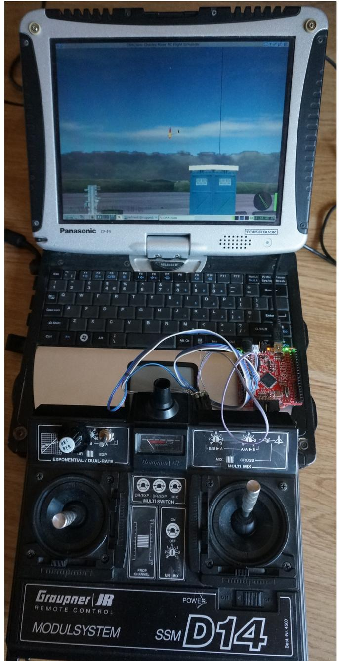
Figure 1: Montage final, avec la radiocommande pilotant le simulateur de vol `crrcsim`
