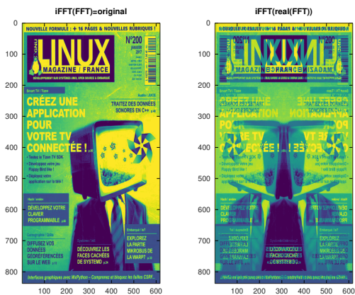
Figure 2: Illustration de l'impact de ne conserver que la partie réelle de la transformée de Fourier de chaque ligne de l'image lors de la transmission : la parité du spectre dans ce cas est clairement visible sur l'image de droite, tandis que l'image de gauche dans laquelle toutes les informations ont été conservées au cours des transformations est restituée à l'identique de l'originale.
