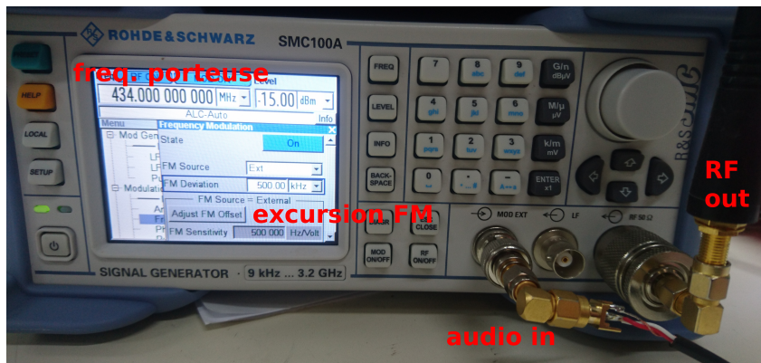
FIGURE 1 – Émission par un synthétiseur radiofréquence modulé en FM par son entrée externe connectée à la carte son d'un PC. L'excursion FM est de quelques centaines de kHz/V. Nous verrons plus loin dans le texte comment utiliser des circuits plus accessibles au grand public.
