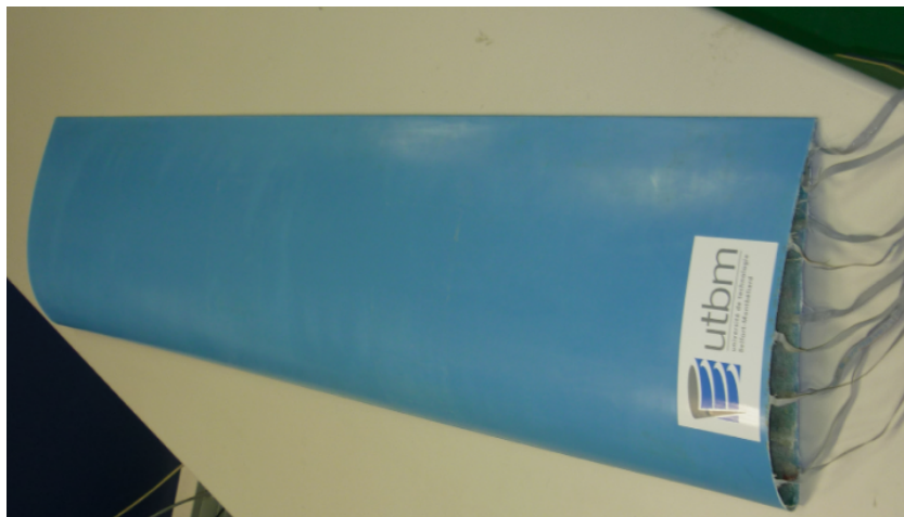
FIGURE 1.25 : Aileron développé à l'UTBM intégrant des éléments piézoélectriques.
