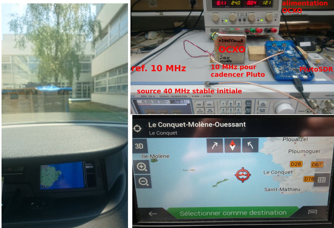
FIGURE 6 – Haut, droite : montage dans lequel l’oscillateur cadencant la PlutoSDR est remplacé soit par la sortie d’un synthétiseur de fréquence référencé sur un maser à hydrogène (ici inutilisé), soit par un quartz contrôlé en température (OCXO). Bas : deux véhicules – Renault (gauche) et Mercedes (bas, droite) – situés sur le parking de l’ENSMM se croient les roues dans l’eau au large de Brest.
