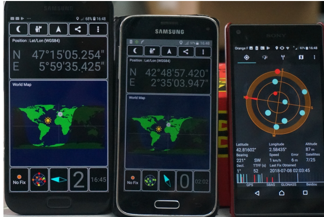
FIGURE 4 – Trois téléphones mobiles sont soumis au signal de leurrage émis par la PlutoSDR : un téléphone Samsung (milieu) et un téléphone Sony (droite) se croient dans le sud de la France, tandis que le Samsung de gauche est resté à Besançon.
