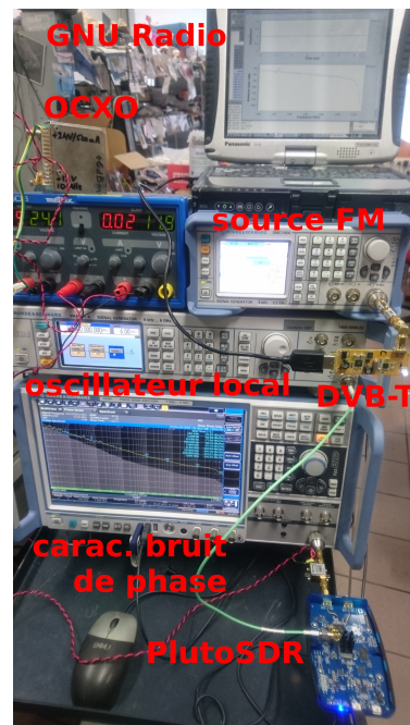
FIGURE 6 – Gauche : caractérisation du bruit de phase des divers émetteurs compatibles avec les applications de radio logicielle. La PlutoSDR est caractérisée soit avec son oscillateur compensé en température (TCXO) d'origine (Rakon RXO3225M) soit avec un oscillateur contrôlé en température (OCXO). Droite : montage expérimental pour la caractérisation de la limite de détection (en haut, SMC100A utilisé comme source de porteuse modulée en fréquence) et le bruit de phase des sources (en bas, FSWP et synthétiseur SMA100A pour fournir le signal de référence à la PlutoSDR).
