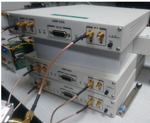
Figure 12: Un assemblage d'USRPs X310 – le haut de gamme de la SDR à usages professionnels compte tenu du prix des récepteurs et des cartes filles – synchronisées en temps et en fréquence pour la caractérisation d'oscillateurs ultra stables.
