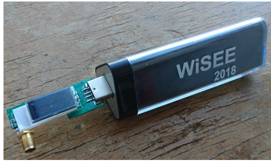
FIGURE 5 – Montage utilisé pour les tests : l’antenne a été remplacée par un connecteur SMA pour les mesures en mode conduit sur analyseur de spectre. Ce connecteur rayonne suffisamment pour démontrer le brouillage de GPS sur un rayon de quelques mètres sans risquer d’affecter les récepteurs à grande distance. Le circuit est alimenté par une batterie fournissant 5 V sur un connecteur USB.
