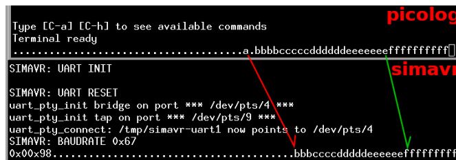
FIGURE 3 – Communication depuis picolog vers simavr émulant un Atmega32U4 et répondant avec le caractère suivant de celui fourni. Lorsque nous tapons 'a' dans picolog (rouge), le microcontrôleur répond 'b' qui s'affiche dans le terminal exécutant simavr ainsi que dans picolog . Nous répétons l'opération jusqu'à 'e' qui se traduit par la réponse 'f' (vert).
