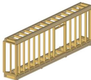
Figure 3. Montants d'ossature
