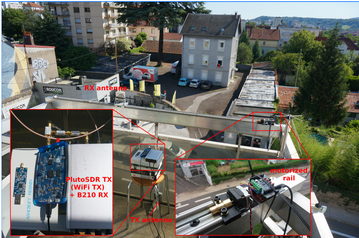
FIGURE 2 – Montage expérimental avec l’antenne d’émission fixe sur le sol du balcon (bas de la photographie), l’antenne réceptrice chariotée sur le rail motorisé fixé sur la balustrade, avec l’émission par la PlutoSDR configurée en générateur de phase pseudo-aléatoire et le récepteur Ettus Research B210 acquérant d’une part le signal de référence émis, d’autre part le signal réfléchi par les cibles. La commande du moteur par une interface X-NUCLEO-IHM14A1 commandée par un microcontrôleur dédié recevant ses ordres par port série virtuel sur USB est visible en encart à droite.
