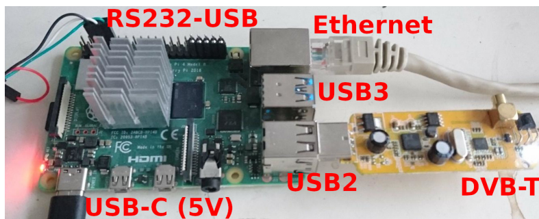
FIGURE 1 – Raspberry Pi 4 équipée de ses interfaces de communication (Ethernet, USB) alimentée en USB-C par un transformateur mural, recevant un flux de données radiofréquences d’un récepteur DVB-T muni d’un R820T2.
