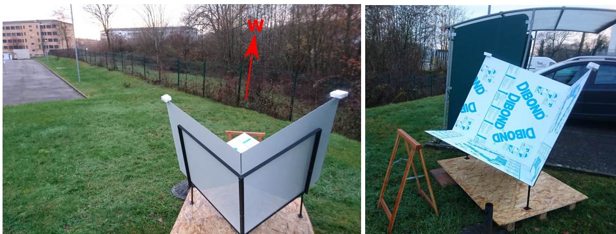
FIGURE 14 – Le catadioptré assemblé par 3 plaques de 1 m×1 m de Dibond sur un chassis de barres soudées à 90° et orienté vers l’ouest.
