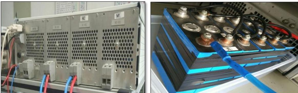
Fig.4.9 convertisseur (gauche), pack de batteries (droite)
