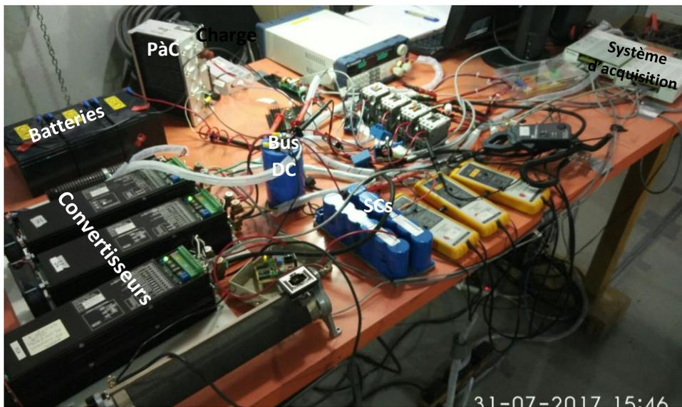
Fig.4. 36 Banc de test pour l'hybridation PàC/Batterie/SC
