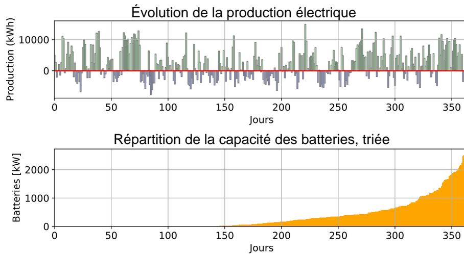
FIGURE 4 – Évolution de la production électrique (différence entre la demande  $D$  du datacenter et la production  $P_{re}$  des sources primaires), et de la capacité des batteries, au cours de l'année.
