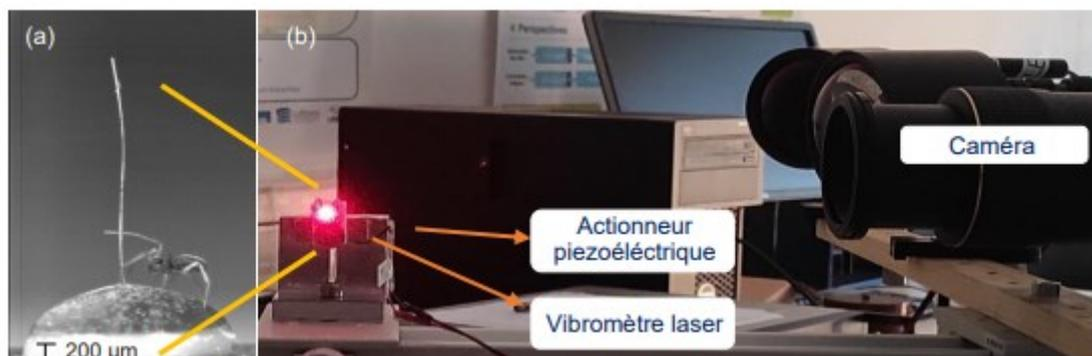
**Figure 1.** (a) fibre de soie encastrée libre ; (b) montage expérimental pour la caractérisation dynamique des propriétés de fibre unitaire
