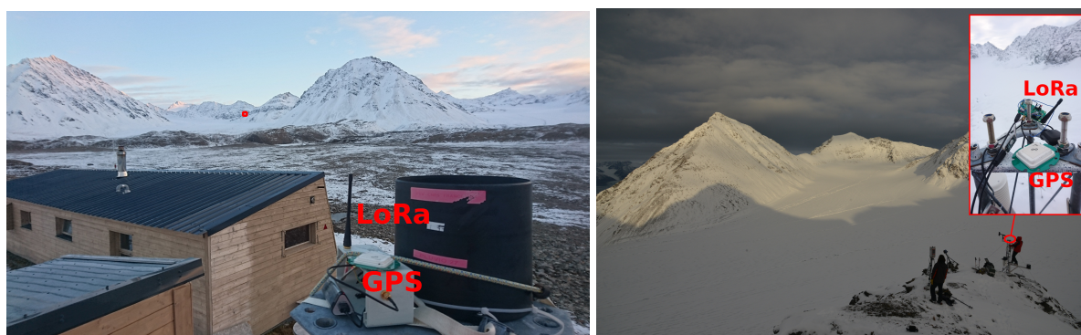
FIGURE 9 – Gauche : installation de la station de base au sommet d'un mat à proximité de la base Jean Corbel (gauche), capable de communiquer avec le rover qui sera, au cours de cette mesure, placé sur un mat (cercle rouge sur la photographie de gauche) portant une station météorologique sur un éperon rocheux surplombant le glacier en cours d'étude (droite). L'analyse qui suivra indique qu'il serait judicieux de placer la station de référence sur cet éperon rocheux pour couvrir tout la bassin glaciaire, sous réserve de trouver une source d'alimentation suffisante pour la durée des sessions de mesures. Au premier plan, l'acquisition du modèle numérique de terrain par LiDAR (photographie F. Tolle, Théma, Besaçon).
