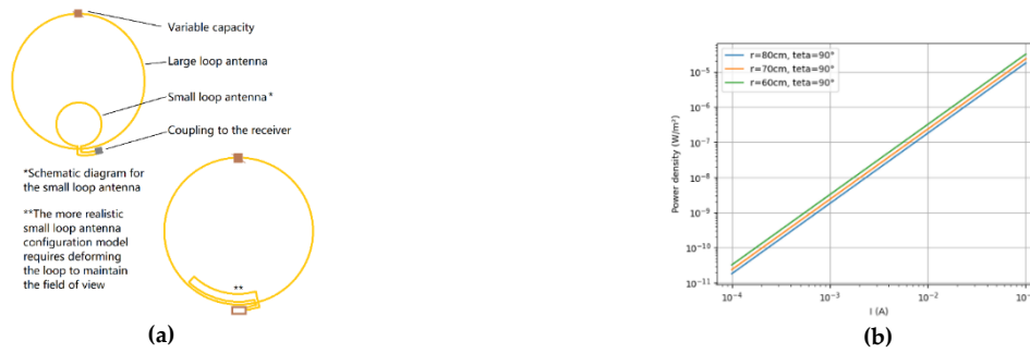
Figure 2. (a) Couplage à l'antenne émettrice-réceptrice, avec la nécessité de maintenir le champ de vision à travers la lentille. Les boucles dorées des antennes sont représentées en jaune or. Le rectangle marron en bas à droite est l'ASIC. (b) Densité de puissance reçue à 80, 70 et 60 cm.
