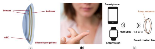
Figure 1. (a) Principe de fabrication d'une lentille de contact, avec antenne, circuit intégré spécifique (ASIC) et capteurs pour communiquer avec une montre connectée ou un mobile. (b) Cliché Freepik illustrant l'échelle et la fragilité d'une lentille de contact standard. (c) Communication entre une lentille de contact intelligente et une montre connectée et/ou un smartphone.
