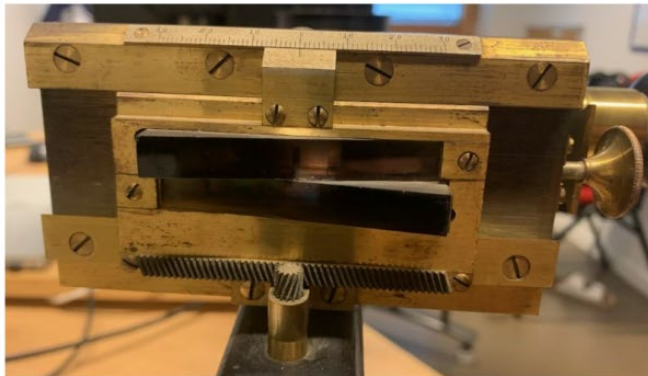
Figure 6 - Photographie (à droite) et schéma (à gauche) des deux prismes absorbants montés tête-bêche (élément a- de la figure 3B). Les rayons rouge et noir sont issus chacun d'une des ouvertures de l'écran et les rayons en pointillés sont trop déviés par les prismes et sont bloqués par la fente d'entrée du spectromètre.
