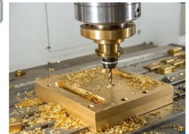
Process soustractif traditionnel appliqué au laiton : Présence de copeaux (déchets)
