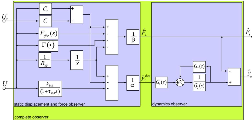
Fig. 3. Block diagram of the actual observer.
