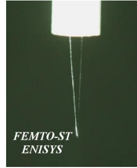
FIG.2 – Microthermocouple de type K (Chromel-Alumel) [10]
