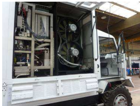
Figure 9 : Vue sur la PAC installée sur la plateforme du Banc ECCE
