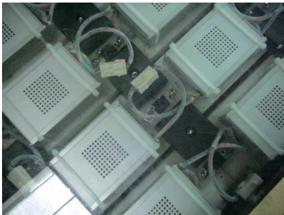
Figure 11 : Vue sur des supercondensateurs
