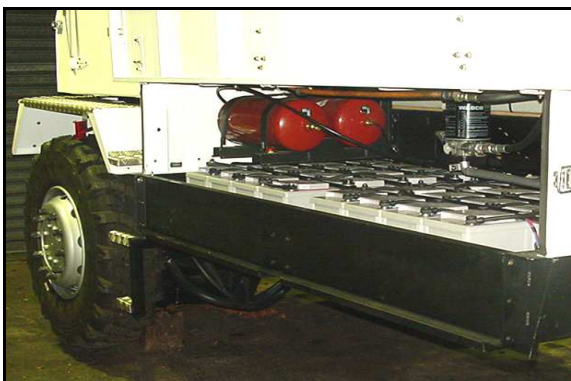
Figure 4 : Implantation des batteries
