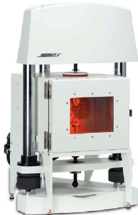
**Figure 1.** Machine de test de traction ElectroForce<sup>®</sup> 3230 Instrument (Bose, Eden Prairie, Minnesota, États-Unis).
