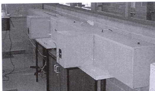
Figure 4 : Caisson acoustique expérimental
